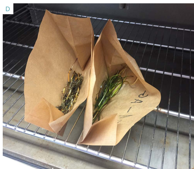
FIGURE 4.8. Photos montrant comment un échantillon de biomasse d'herbier marin est traité dans le laboratoire: A) séparation de la biomasse aérienne (feuilles) et souterraine (rhizomes et racines), B) pesage du sac en papier vide étiqueté avant d'y mettre la biomasse, C) pesage du sac en papier avec la biomasse à l'intérieur, D) séchage de la biomasse dans le four. Photos par: C.B. de los Santos.
